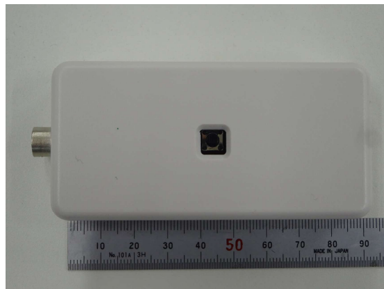
図 2 : チャンバー用超高輝度 LED システムに接続する遠隔操作ユニット
