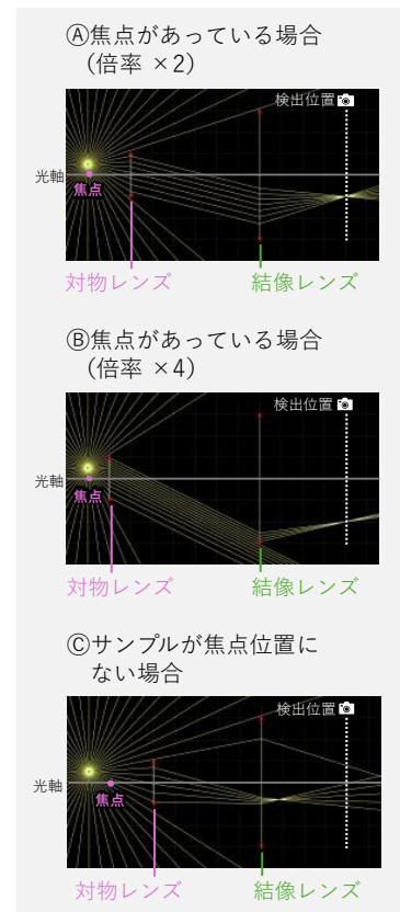
図1. レンズ2枚による結像を示す光路図
