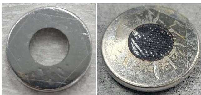
図 2. PP フィルムを使用したコインセル窓材に PP フィルムを貼った状態(左)とコインセルを構築した状態(右)
