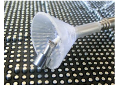
図2 ペンの磁石吊り下げ機構
