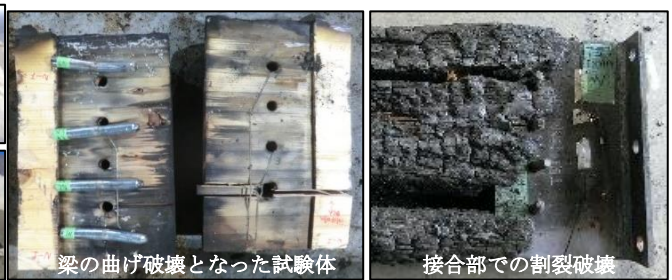
図4 実験後の接合部（解体後）
