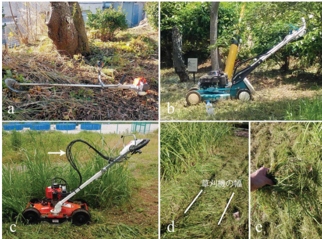
図2. 使用機材。a 刈払機、b 芝刈機、c 草刈機（矢印：ケーブルがむき出しになっている）、d 草刈機の走行跡、e 刈られた雑草。
