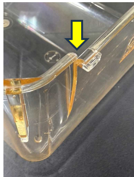
図 1 : ケージ割れの例（黄色矢印）
