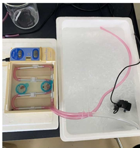
図 2. 冷却機能を新設した電気泳動装置
