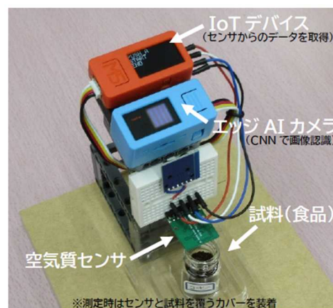
図 2. CNN を用いた臭覚認識システムの試作例
