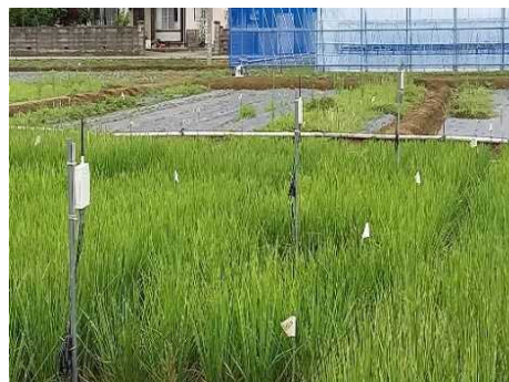
図 1. 生命科学研究科附属 湛水生態系野外実験施設の塩害水田圃場における塩濃度モニタリングの様子および土壌センサ情報
