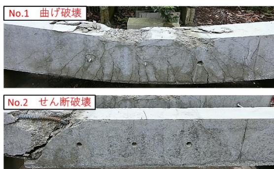
図4 破壊状況写真（曲げ破壊・せん断破壊の例）
